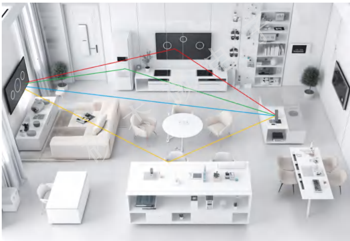
图 电磁波在室内对同一个目标物反射信号的不同路径
